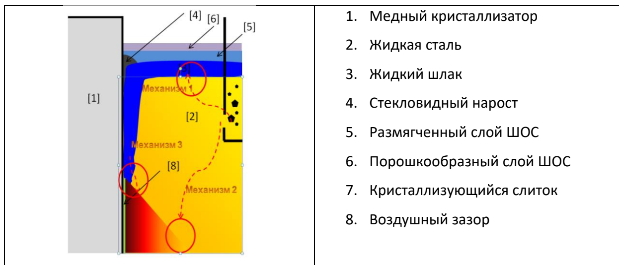
Рисунок 35 – Схематичное изображение механизмов загрязнения стали экзогенными неметаллическими включениями, приводящими к появлению дефектов поверхности;
