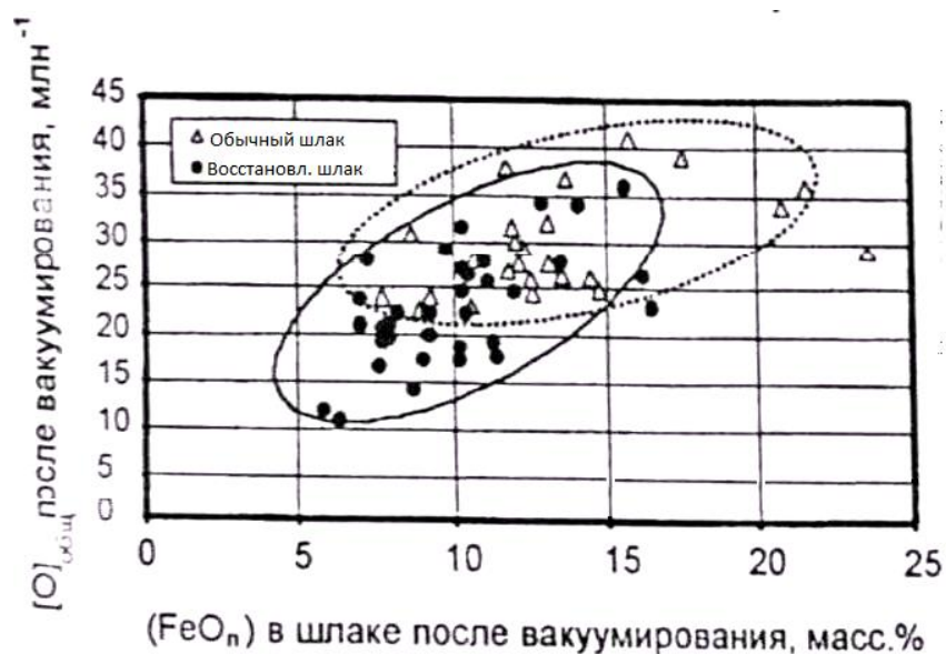
Рисунок 5 – Влияние окисленности шлака на содержание общего кислорода после вакуумирования [4];
